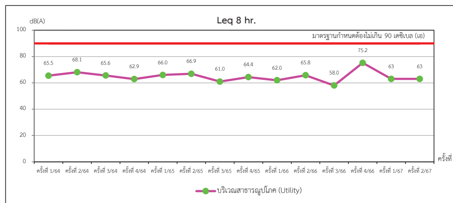
ภาพที่ 4.65 กราฟแสดงผลการตรวจวัดระดับเสียงในพื้นที่ทำงาน (Leq 8 hr.) บริเวณสาธารณูปโภค (Utility)
