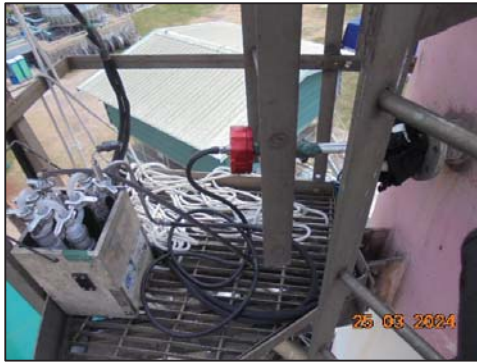
รูปที่ 4.2 การเก็บตัวอย่างคุณภาพอากาศในปล่องระบาย บริเวณ ปล่อง Dowtherm Boiler No. 3
