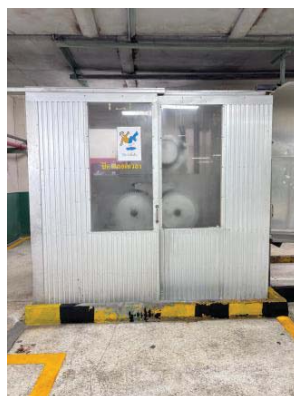
รูปที่ 26 ห้องเก็บเสียงครอบเครื่องจักร
