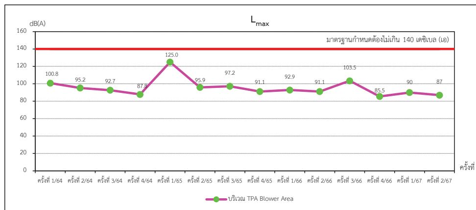
ภาพที่ 4.73 กราฟแสดงผลการตรวจวัดระดับเสียงในพื้นที่ทำงาน ( L_{max} ) บริเวณ TPA Blower Area
