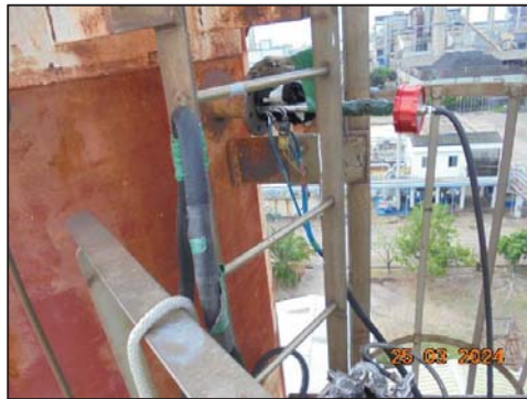
รูปที่ 4.3 การเก็บตัวอย่างคุณภาพอากาศในปล่องระบาย บริเวณ ปล่อง Dowtherm Boiler No. 5-6
